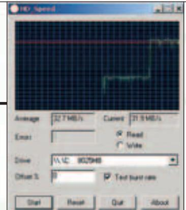
**HD Speed** – маленькая, но очень функциональная программа, созданная лишь с одной целью – оценить скорость работы приводов. Утилита тестирует жесткие, оптические и гибкие диски.
